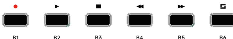
X8HIII 的 6 个走带按键共有 3 种模式：MCU 模式（默认）、HUI 模式和 CC 模式，您可通过设置模式切换这 3 种模式，详细操作步骤请参考 [3.2 更改 B1 ~ B6 按键的模式](#)。
